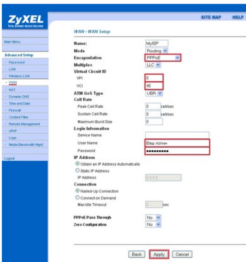
Откроются настройки WAN - интерфейса модема. Выставляем параметры как показано на рисунке. В полях User Name и Password введите логин и пароль для доступа в интернет, выданные компанией Элитком. Поле Service Name оставляем пустым, значения параметров VPI и VCI (0 и 40 соответственно). Кнопка Apply.
